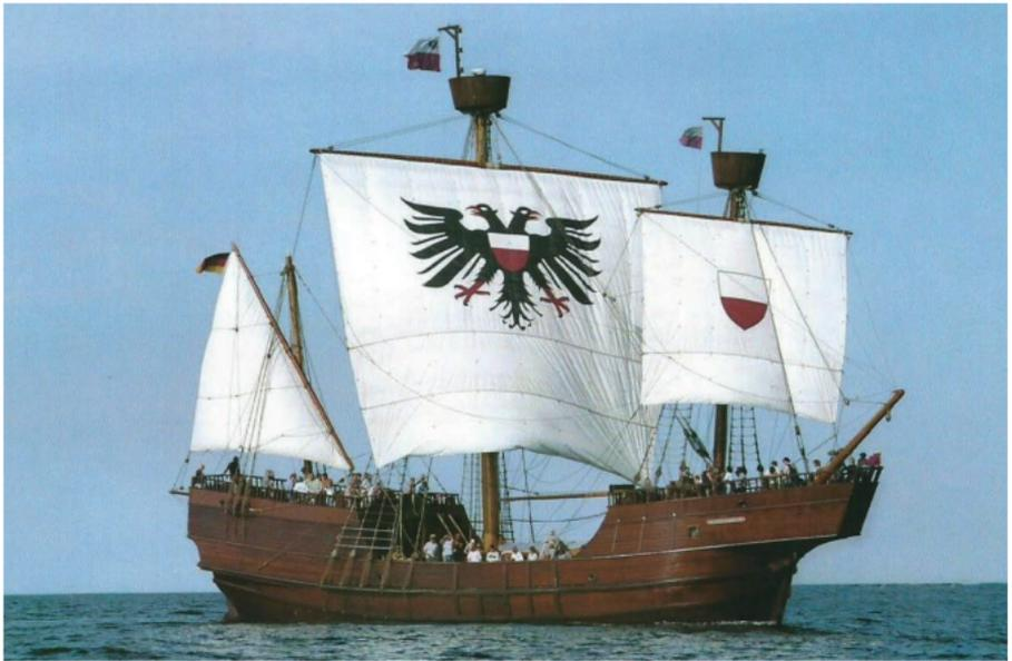
*Länge 35,9 m, Breite 9,3 m, Verdrängung 198 t, 3 Masten, Segelfläche 276 qm, gebaut von 1999 bis 2004*
