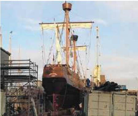
die Crew das Unterwasserschiff mit einem Hochdruckreiniger gereinigt, die Anoden demontiert, die Ankerkette ausgefahren sowie das Ruderblatt zum Ziehen der Welle vorbereitet. Im Anschluss erfolgte noch eine Begehung durch die Berufsgenossenschaft. Am Tag darauf wurde der Propeller durch die Firma Schaffran demontiert sowie die Schwanzwelle gezogen. Parallel dazu hatte die Werft ihre umfangreichen Holzarbeiten am Rumpf begonnen.
