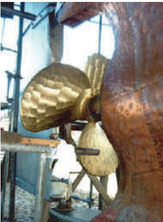
Sowohl das Hanseschiff "Lisa von Lübeck" als auch das Hanseschiff "Wisseмара" wurden mit einer Schaffran Wellenanlage mit Propeller ausgerüstet.
