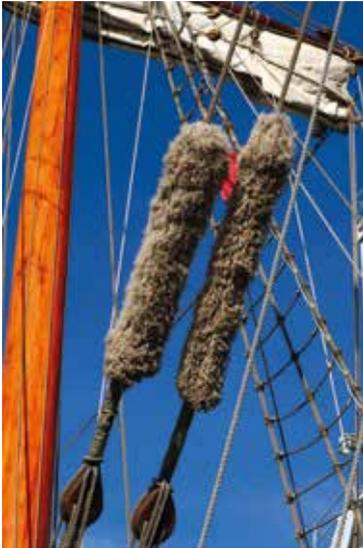
Auf Segelschiffen dient der Tausendfüßler dazu, ein unerwünschtes Scheuern von Tauwerk an Segeln oder anderen Ausrüstungsgegenständen zu verhindern. Er wird aus unbrauchbaren Resten von Tauwerk geflochten. Etwa zwanzig Zentimeter lange Stücke werden in Kabelgarne zerpfückt und einzeln oder paarweise zwischen gespannten Garnen mit einem Ankerstich eingeflochten. Der fertige Tausendfüßler wird an der gefährdeten Scheuerstelle um die Tawe oder Stahlseile gewickelt und fixiert.
