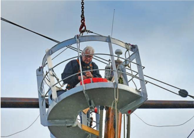
Ein Autokran hob den Korb mit Christian Gärtner an den Topp, damit er beides abbauen und am Kabel herablassen konnte. Nachdem ein Stropp zum Hieven angeschlagen war, verlief das Ausheben des Mastes ohne Probleme. Nach dem Ablegen an der Pier wurde er abgetakelt und anschließend das stehende und laufende Gut sowie der Mast selbst in die Halle verbracht.
