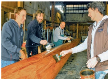
Eric Janssen und Heino Schmarje lackieren den neuen Fockmast der Lisa von Lübeck
