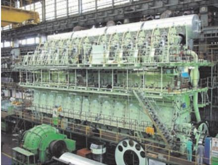
12 Zylinder-Schiffsdiesel der Firma MAN
