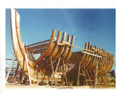
Bis Dezember 2000 standen die Grundkonstruktion, 42 Spanten, der 3 Tonnen schwere Steven und das Spiegelheck.
