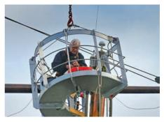
Ein Autokran hob den Korb mit Christian Gärtner an den Topp, damit er beides abbauen und am Kabel herablassen konnte. Nachdem ein Stropp zum Hieven angeschlagen war, verlief das Ausheben des Mastes ohne Probleme. Nach dem Ablegen an der Pier wurde er abgetakelt und anschließend das stehende und laufende Gut sowie der Mast selbst in die Halle verbracht.
