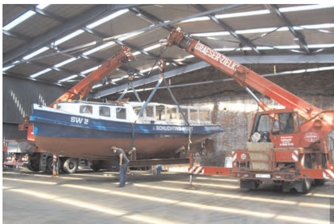
Kranen im Frühjahr nach erfolgten Restaurierungsarbeiten
