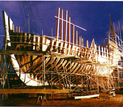
Gedämpft wurde in der Steamkiste. Das ist eine 10 m lange isolierte Holzröhre durch die Dampf strömt. Während des ca. dreistündigen Dämpfens sind die Holzfasern geschmeidig gekocht worden. Nur so ließen sich die Planken extrem biegen ohne zu brechen. In einem extra konstruierten Biegestell (Foto) wurden die Planken ent-
