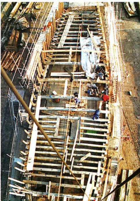
*Auf dem Hauptdeck werden Deckbalken und Schlingen angepasst.*
