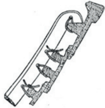
Verschnürung der Spanten mit den geklinkerten Planken und dem Dollbord
