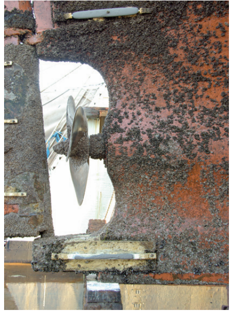
Propeller und abgenutzte Opferanoden
