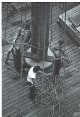
Takelarbeiten – insgesamt sind am Schiff über 4200 m stehendes und laufendes Gut
